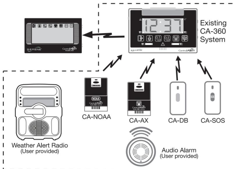
Il s'agit d'un cas typique d'ajout d'un récepteur à distance à un système CA-360 afin d'améliorer la facilité d'utilisation et la zone de couverture.
