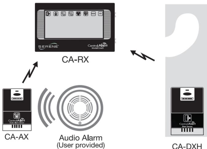
Le cas 2 montre comment un système d'alerte sans fil simple peut être créé avec le CA-RX. Il vous avertit quand quelqu'un est à la porte, ou si un détecteur de bruit est activé. L'ensemble du système est compact, léger et est idéal pour un usage en voyage.
